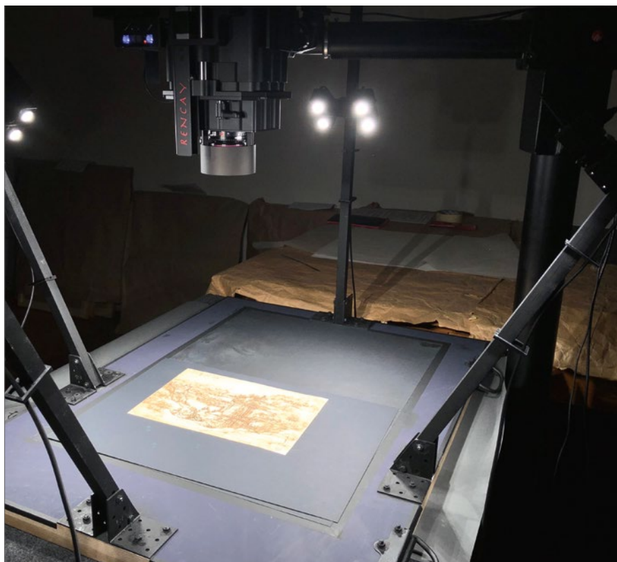
Der Einsatz eines Rencay-16K-Scanbacks mit 1.248 Mio. Pixeln ermöglichte eine achtfache Vergrößerung des Originals und das Herausarbeiten auch kleinster Details.
